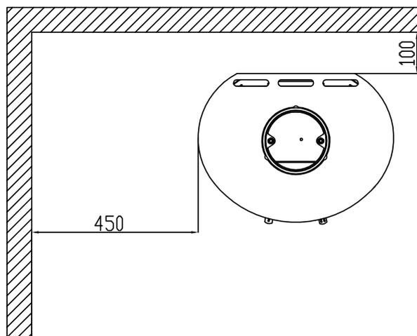
Distance au mur réfractaire, avec tuyau isole
